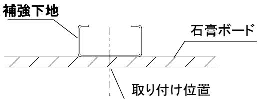
補強下地は厚み 1.6mm 以上の鋼材を示します。通常の天井下地材(LGSなど)では、本製品の重量に耐え切れず、天井から落下しますので、補強していない天井下地材に本製品を取り付けることは絶対にしないでください。
