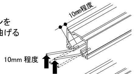
○曲がったジョイントピンを枠に差し込む
