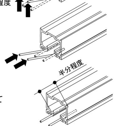
○ジョイントピンは半分程が枠に入っているように差し込む
