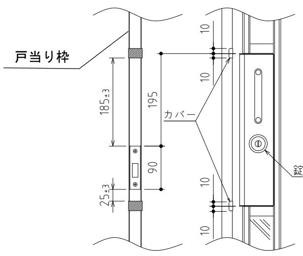
錠納まり参考図(ストライク・カバー取付位置確認用)
