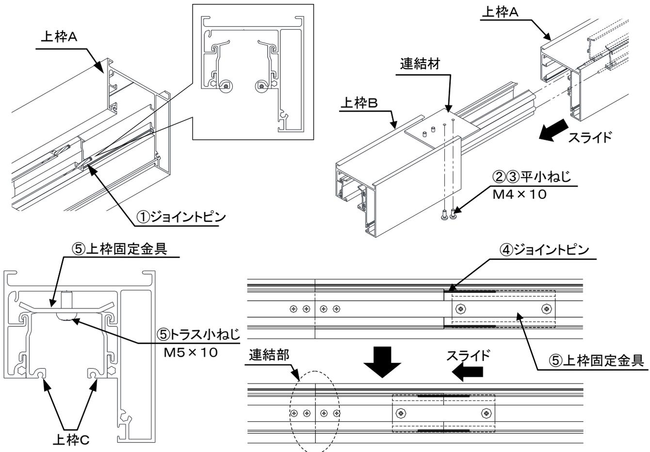
上枠をスライドさせて連結ができない場合は、上枠固定金具のトラス小ねじを緩め、上枠固定金具を取外し、上枠Cを取外すことで、スライドさせなくても連結が可能です。
