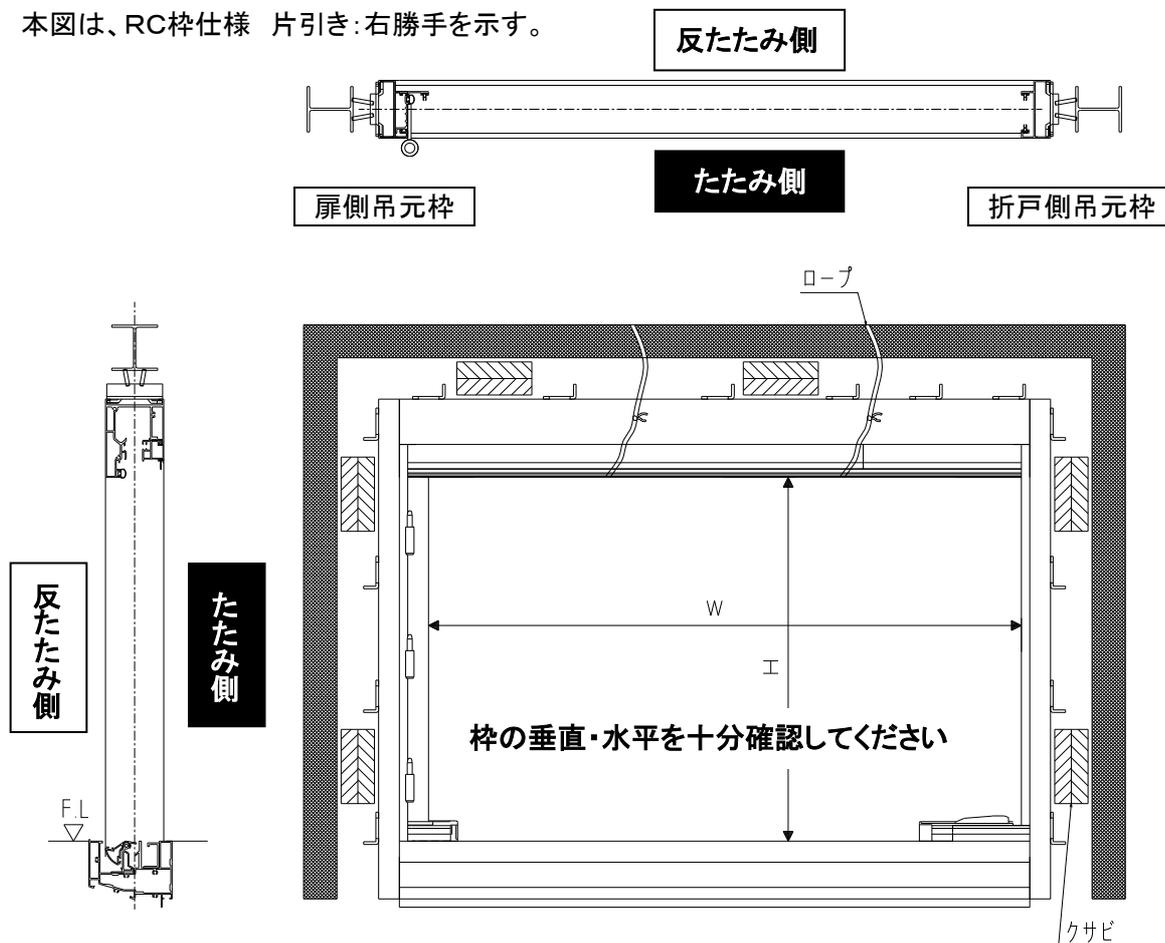
・アンカーは、必ず2カ所溶接して固定します。
