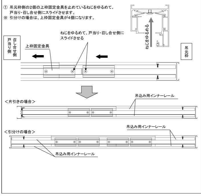
② 吊元側に取り付けてある吊込み用インナーレールを外します。 ※引分けの場合は、取外し箇所が両吊元枠側に2ヶ所あります。 上枠固定金具 (ストッパー付き)
