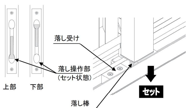
3. 扉を全閉し、引手にある落し操作部を操作し、落し棒をセット状態にしてください
