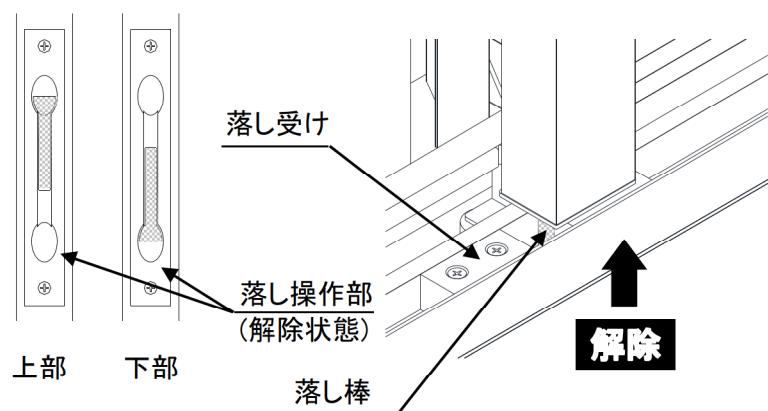
1. 引手にある落し操作部を操作し、落し棒を解除してください
