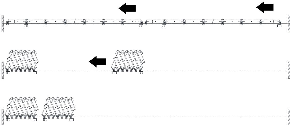
扉が全開しましたら、戸先の落しを操作し、セット状態にしてください。
