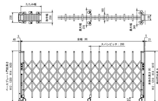
※内観左: ベースプレート門柱納まり、内観右: 壁付け門柱納まりを示す
